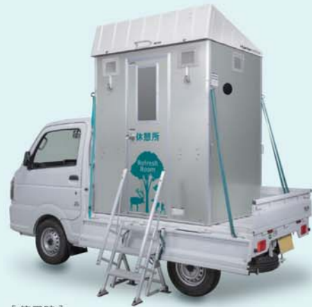
【使用時】 ※屋根は上げた状態で使用。※ベルト固定方法はイメージです。製品固定用のベルトは付属されておりません。 ※昇降用タラップは標準装備。走行時は室内へ格納します。
